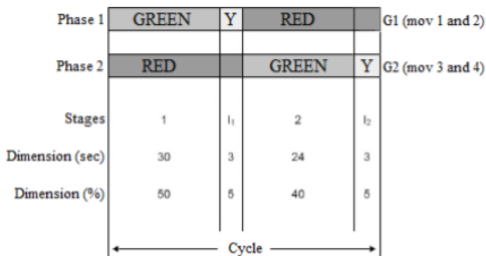
Figura 3 - Diagrama de tempo com duas fases e duas etapas. Adaptado de DENATRAN (1984)
